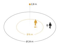
Hauteur d'instal lation: 2,50 m – 6,00 m Orange: sens de passage radial Noir: sens de passage tangentiel
